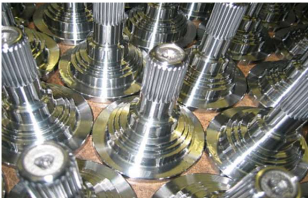
Kaltwalz-Anwendung ist die Herstellung von zylindrischen verzahnten Werkstücken.
