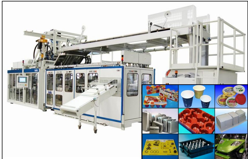
Druckluftformautomat RDM 75 K 3. Gen. zur Herstellung von Lebensmittelbechern • Ausstoß 100'000 Becher pro Stunde in Polystyrol • 40 Takte pro Minute bei einem Becherdurchmesser von 75mm
